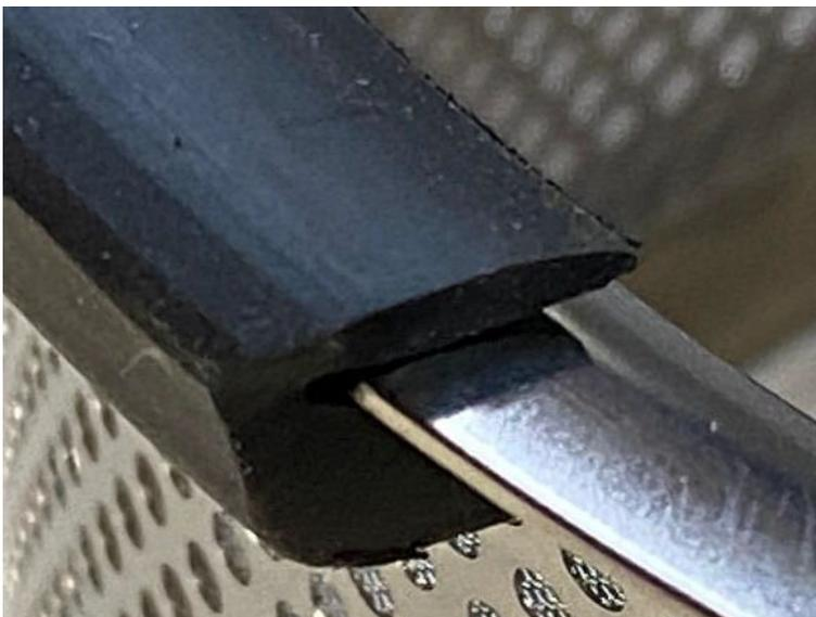
Die Nut der Profildichtung auf den Außen-Durchmesser des Wisy-Filtereinsatz schieben.
