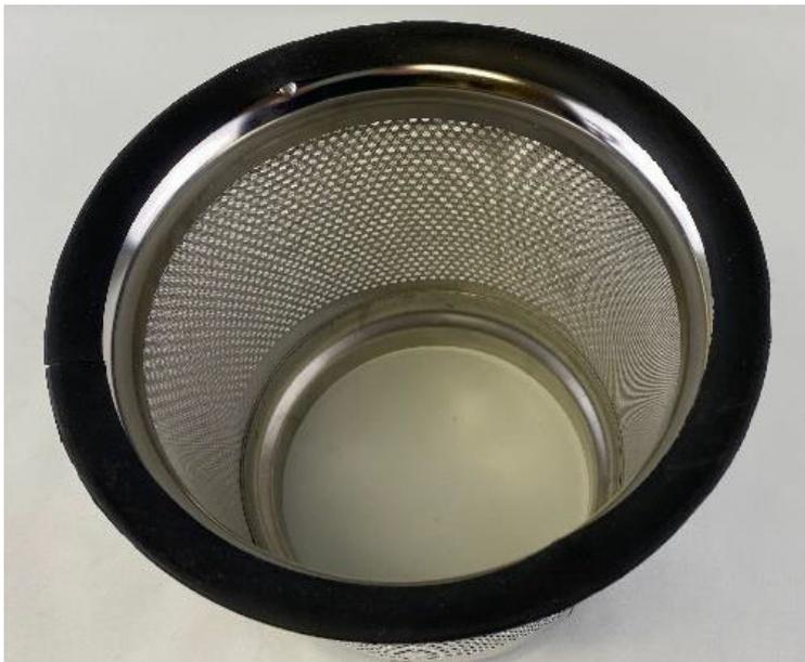
Filtereinsatz mit montierter Dichtung
